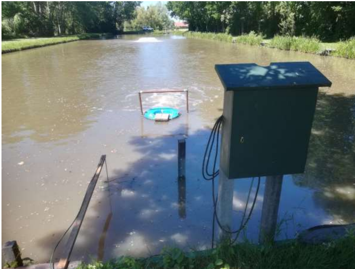
Foto van een praktijksituatie. Op de voorgrond links de zuurstofsensoren van Linn ACO230 (Aqua-Control One) en de schakelkast. Dan een turboJet beluchter (Turbo-Jet 0,75 kW) en een paddestoelbeluchter (Aqua Pilz
